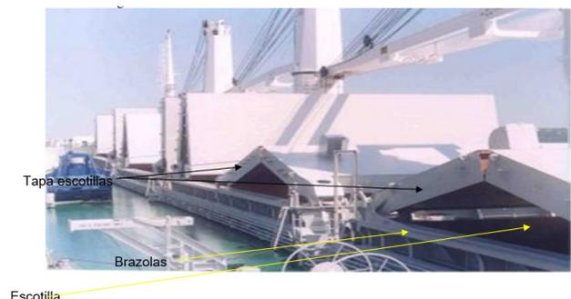
Figura 14. Partes de la cubierta principal de un barco.
